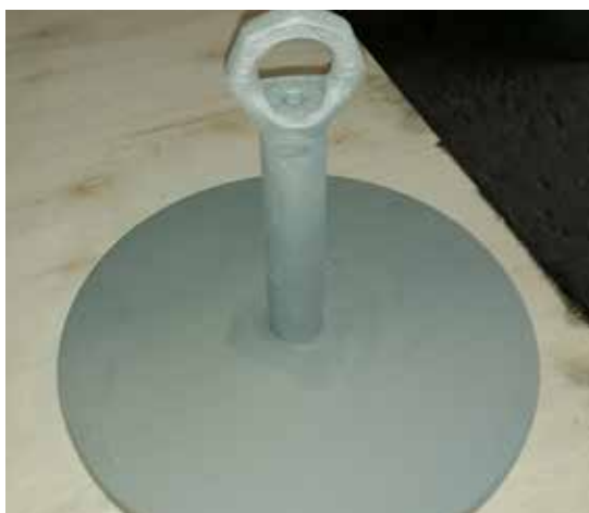
Kantig mit Korund gestrahltes Bauteil
