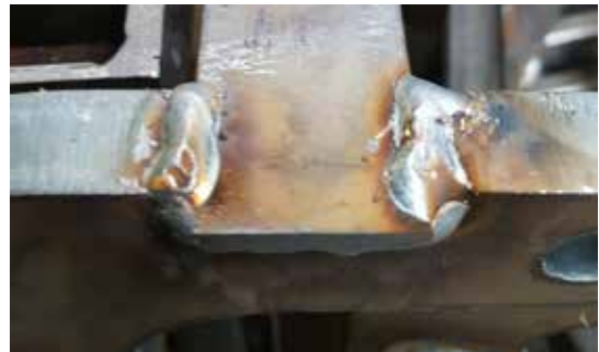
Schweißteil mit Zunder- und Fetteinbrand
