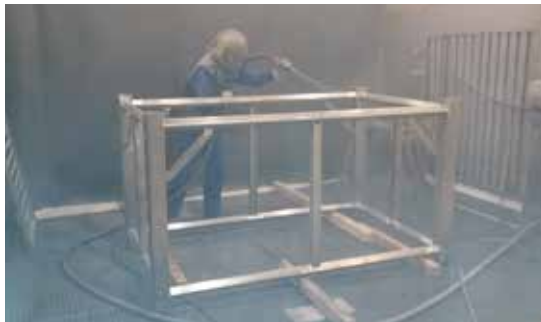
Sandstrahlen im Freistrahlaus
