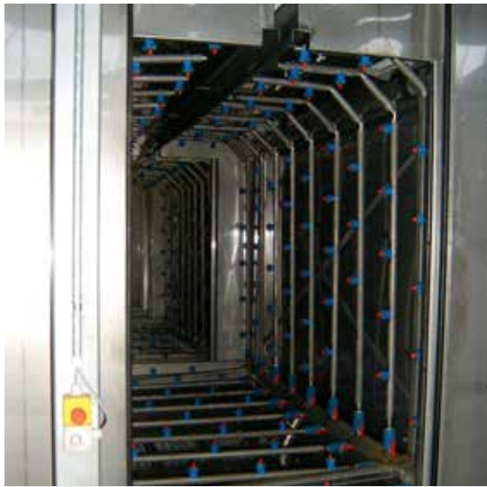
Anlage zur chemischen Vorbehandlung
