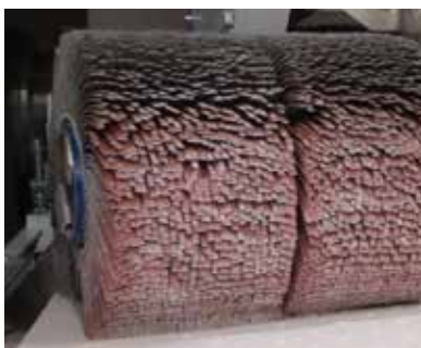
Schleiflamellenwalze (Quelle: www.blech-entgratung.de)
