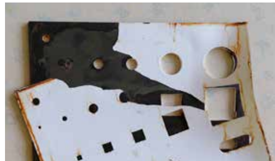
Probestück ohne Kantenverrundung; Vollenthaftung nach 250 h NSS
