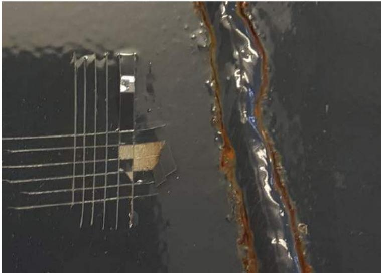
**Abbildung 14: Projekt C5-Prüfblech mit nicht vorbereiteter Schweißnaht nach bereits 168 h neutralem Salzsprühstest.**
