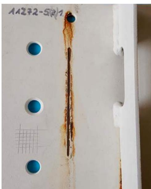
**Abbildung 20: Detailansicht einer Probe, die die aktuell gültigen Normanforderungen einer C5 Korrosivitätskategorie erfüllt. Im Spalt sichtbare Korrosion könnte noch durch eine zusätzliche Abdichtung vermieden werden**
