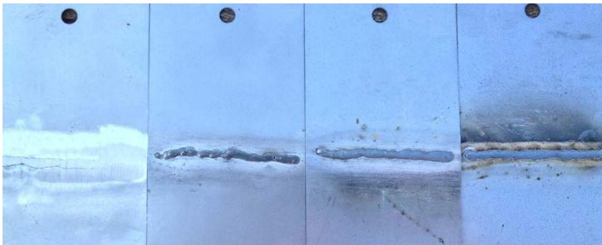
**Abbildung 12: Schweißnähte in absteigendem Reinigungsgrad**
