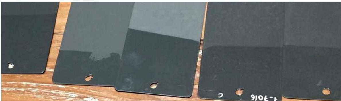
**Abbildung 6: Feuchteschäden an pulverbeschichteten Aluminiumplatten:**
