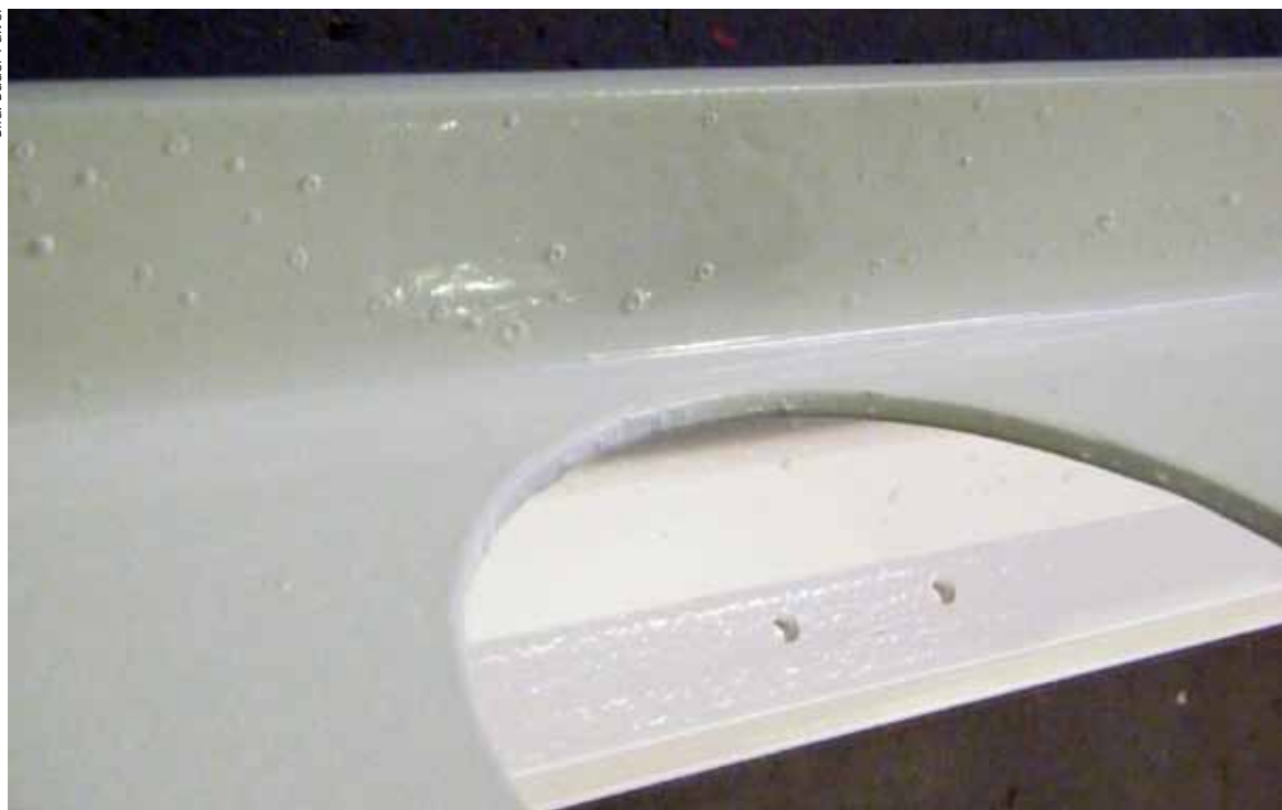
Bild 1: Pusteln auf einem lackierten Bauteil. Sie können auftreten, wenn das feuerverzinkte Bauteil nach dem Einbrennen der Grundierung noch mit einem Decklack versehen wird.
